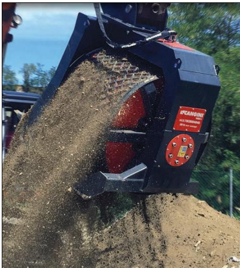
Figura 11 – Fasi di separazione meccanica del rifiuto tramite rotovagliatrice.
